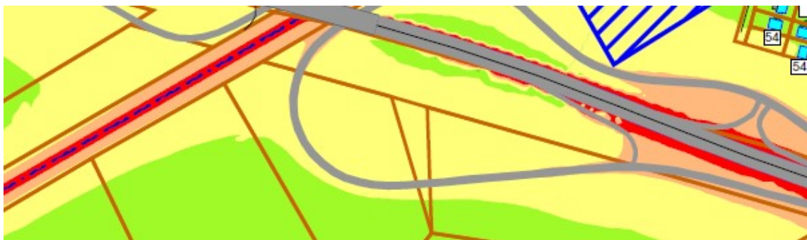
Joonis 6 Väljavõte Tallinna ringtee km 30,1 – 34,5 Kanama - Valingu põhiprojektist: liikluse müra modelleerimine”, 2040 ehitusjärgne olukord müratõkkeseinteta kaardist öisel ajal.
